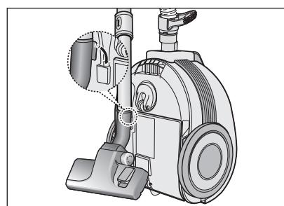
Zur Aufbewahrung hängen Sie die Bodendüse am Staubsauger ein.
