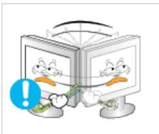
⚠ Ne pas déplacer le moniteur de droite ou à gauche en tirant sur le cordon d'alimentation ou sur le câble vidéo.
