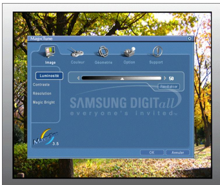
Pour tous les moniteurs, le mode OSD facilite le réglage des paramètres. Lorsqu'ils sont sélectionnés, chaque onglet de la fenêtre de contrôle affiche une description générale des éléments de réglage du sous-menu. Lorsqu'ils sont sélectionnés, chaque onglet affiche une liste de menus. Pour un réglage rapide des paramètres du moniteur, le mode OSD vous permet un accès facile et agréable aux différents onglets et éléments de sous-menus.
