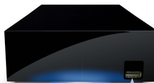
Port USB pour connexion d'un disque dur, lecteur flash, imprimante, ou appareil photo numérique
