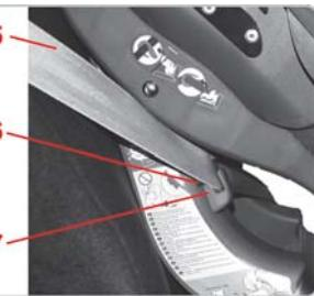
☞ Introduisez la ceinture ventrale **12** dans le guidage **13** situé en regard du fermoir de la ceinture du véhicule, sur la partie inférieure du siège.
