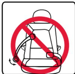
**6** Ceintures sous-abdominales avec une patte de bouclage cousue et un rétracteur qui ne bloque qu'en cas d'arrêt soudain.
