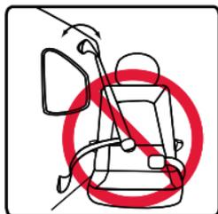
**1** Les ceintures baudrier & sous-abdominale avec points d'ancrage du haut et du bas sur la porte du véhicule.
