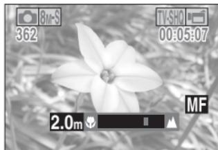
**3** Appuyez sur le bouton [**◀**] ou [**▶**] pour régler la distance de mise au point et appuyez sur le bouton de réglage **SET**.
