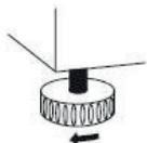
Pour son fonctionnement sans vibration, l'appareil doit être mis à niveau. Pour cela, ajustez les pieds avant réglables en hauteur afin d'équilibrer correctement l'appareil.
