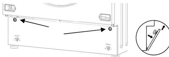
**Modèle pose libre** – Introduire un petit tournevis dans les fentes se trouvant sur la partie avant du socle puis exercer une légère pression vers le haut afin de libérer la partie supérieure du socle de l'appareil.
