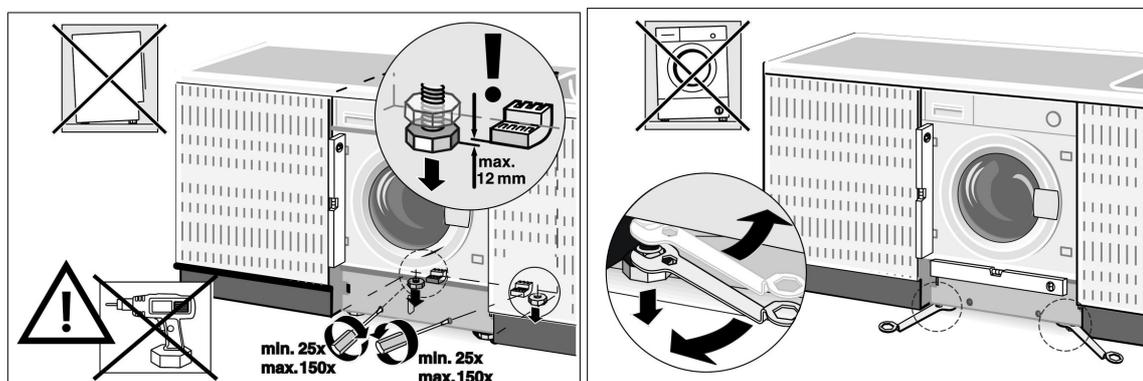
Les tuyaux pour l'arrivée et l'évacuation de l'eau peuvent être orientés vers la droite ou vers la gauche pour permettre une bonne installation.
