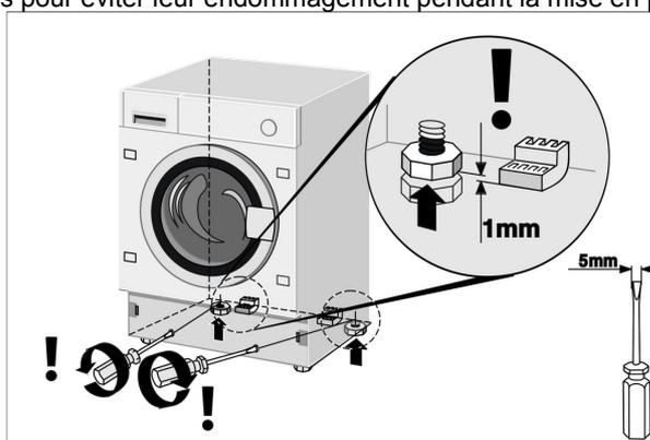
Après avoir encasté l'appareil dans la cuisine, lever les pieds arrière pour éviter que l'appareil pose sur les patins. Après avoir levé les pieds arrière, mettre l'appareil de niveau et fixer les pieds avant.
