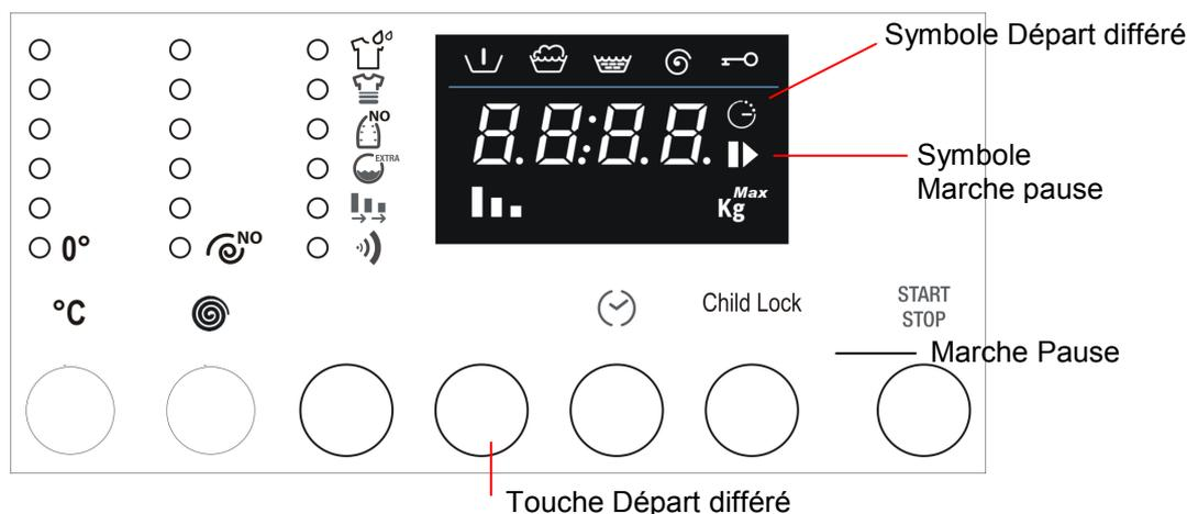
1. En pressant plusieurs fois la touche Départ différé, il est possible de sélectionner après combien de temps le programme de lavage pourra terminer. Le temps à la fin du cycle tient compte de la durée initiale du cycle de lavage, des sélections faites (température, vitesse d'essorage et options), qui peuvent réduire ou prolonger la durée initiale du cycle et du temps d'attente que l'utilisateur veut ajouter avant le départ.
