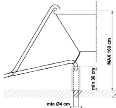
L'extrémité libre sera placée à une hauteur comprise entre **30 et 100 cm** et ne devra jamais être recouverte par l'eau. En présence de tuyaux de rallonge disposés horizontalement, pour un maximum de 3 m, positionner le tuyau d'évacuation à une hauteur maximale de **85 cm** du sol.
