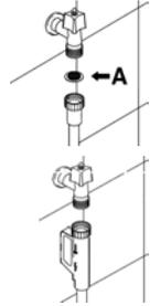
Il est possible d'alimenter le lave-vaisselle avec de l'eau **ne dépassant pas 60°C**. En alimentant l'appareil avec de l'eau chaude, le temps de lavage sera abrégé de 20 minutes environ, mais son efficacité sera toutefois légèrement réduite. Le raccordement devra être effectué à la prise domestique d'eau chaude et selon les mêmes modalités décrites pour le raccordement à la prise d'eau froide.
