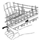
Version B : réglable sur trois positions des deux côtés. Les côtés du panier doivent toujours être positionnés à la même hauteur.
