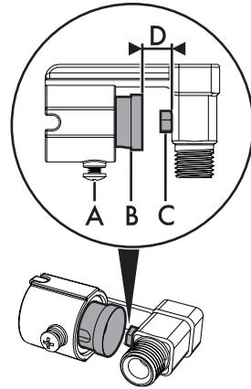
1. Desserrez la vis **A** et poussez à fond le régulateur d'air **B**.
