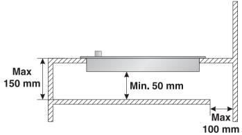
IMPORTANT : si l'appareil est monté sur un meuble, prévoyez l'installation d'une tablette de séparation d'après la figure.
