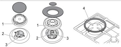
Au niveau de chaque manette est indiqué le brûleur correspondant. L'appareil est équipé d'un dispositif d'allumage électrique. Il suffit d'enfoncer et de tourner la manette en sens inverse horaire sur le symbole de la flamme maximum  $\Delta$ , jusqu'à ce que le brûleur s'allume.
