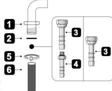
avoir serré les embouts, enfilez le tuyau du gaz 6 sur l'embout 3 ou 3+4 et fixezle avec le collier 5 conforme à la réglementation en vigueur.
