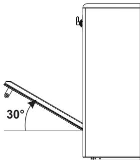
3. Pour remonter la porte, introduisez les charnières dans les fentes prévues à cet effet sur le four en vous assurant que les rainures **A** sont complètement posées contre les fentes. Abaissez la porte et après l'avoir positionnée, sortez les pivots des trous des charnières.
