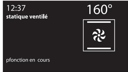
3. L'appareil commence la phase de préchauffage. L'afficheur indique la fonction choisie, la température présélectionnée, l'heure actuelle et l'avance du préchauffage jusqu'à la température souhaitée.
