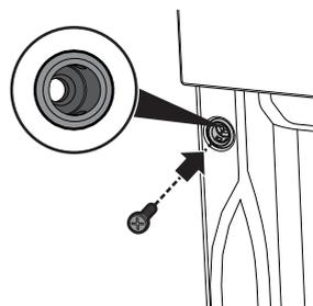
Couvrez les douilles avec les bouchons démontés précédemment.
