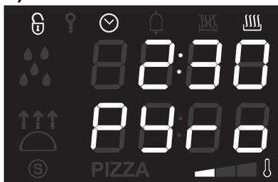
4. L'afficheur indique le message « Pyro » et le temps restant pour signaler que l'appareil est en train d'effectuer le cycle de nettoyage automatique.
