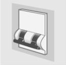
Wird das Gerät fest an das Netz angeschlossen, ist in der Zuleitung des Geräts an einer gut erreichbaren Stelle in Gerätenähe ein allpoliger Trennschalter mit einem Öffnungsabstand der Kontakte von mindestens **3 mm** vorzusehen.
