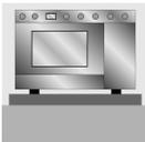
WIRD DER BACKOFEN AUF EINEN SOCKEL GESTELLT, SO MUSS ER SO INSTALLIERT WERDEN, DASS ER NICHT VOM SOCKEL RUTSCHEN KANN.
