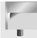
VOR DER INBETRIEBNAHME DES GERÄTS MÜSSEN ALLE ETIKETTEN UND SCHUTZFOLIEN INNEN UND AUSSEN ENTFERNT WERDEN.
