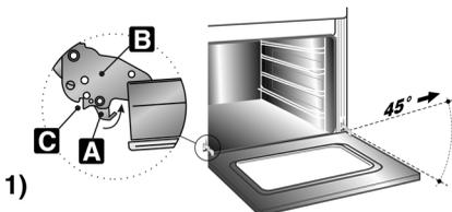
Lever la porte vers le haut en formant un angle d'environ 45° et l'extraire. Si les charnières ne se sont pas bloquées, répéter l'opération en levant les leviers **A** en maintenant la porte légèrement soulevée. Pour le remontage, enfilez les charnières **B** dans les fentes prévues, puis laissez la porte poser vers le bas en s'assurant qu'elle est bien bloquée dans les fentes **C** et baisser les leviers **A**.
