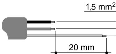
Si l'on doit remplacer le câble d'alimentation, démonter le carter arrière en dévissant les vis. La section du câble ne doit pas être inférieure à 1,5 mm<sup>2</sup> (câble de 3 x 1,5) et il doit résister à des températures jusqu'à 90°C (H05V2V2-F ou H05RR-F). S'assurer que les câbles suivent le parcours optimal et utiliser des colliers à fixer latéralement au meuble, afin d'éviter tout contact avec le four.
