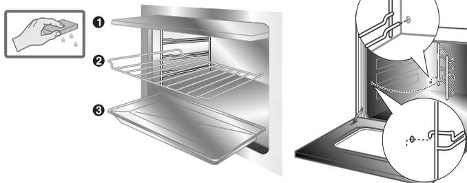
Nettoyer les grilles du four avec de l'eau chaude et des détergents non abrasifs, rincer et essuyer. Pour faciliter le nettoyage, on peut enlever la porte (voir paragraphe « 14.2 Démontage de la porte »)
