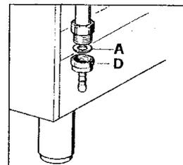
Utiliser un régulateur de pression sur la bouteille conforme à la Norme en vigueur et un tube souple conforme à la Norme XPD36-110.
