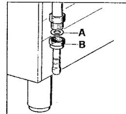
Utiliser un tube souple conforme à la Norme NFD36-102. Visser l'embout «B» à l'extrémité du tuyau de l'appareil en interposant le joint d'étanchéité «A», enfiler avec soin le tube souple et fixer le tube à l'embout avec des colliers de sécurité.
