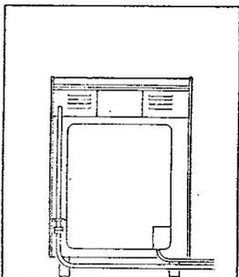
Quand on effectue le raccordement au réseau du gaz avec un tube souple ou un tuyau flexible spécial, utiliser uniquement les types conformes aux normes en vigueur. Le diamètre intérieur du tuyau doit être:
