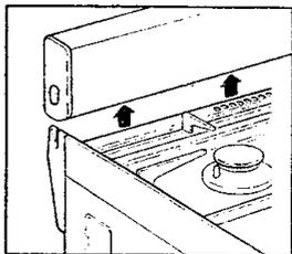
Sur demande, il est possible de monter sur tous les appareils, à la place du couvercle en verre, un dosseret amovible pour faciliter le nettoyage.
