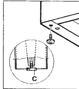
Prendre les quatre pieds qui se trouvent dans le sachet en plastique, à l'intérieur du four. Introduire la partie filetée des pieds dans les trous appropriés sur le fond de l'appareil. Tourner la partie inférieure pour une mise de niveau facile et un alignement parfait avec les autres meubles.
