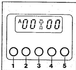
Le programmateur peut être utilisé comme minuterie sans interrompre le fonctionnement du four. Appuyer sur la touche (1), sur le cadran apparaît 0.00 fixe; la maintenir enfoncée et agir sur la touche + ou - pour régler les minutes fixées.
