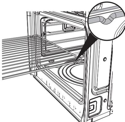
**Le dispositif de blocage mécanique (ou le dossier s'il est présent) doit toujours être tourné vers l'arrière du four.**
