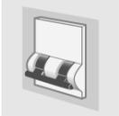
Si l'appareil est branché au secteur par un branchement fixe, il faut prévoir sur la ligne d'alimentation un dispositif d'interruption omnipolaire avec distance d'ouverture des contacts égale ou supérieure à **3 mm** placé de façon à être atteint facilement et proche de l'appareil.
