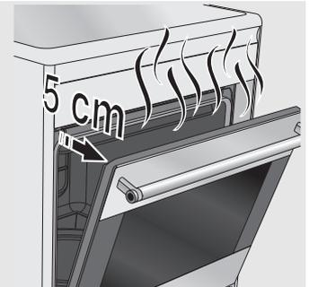
En fin de cuisson, pour éviter des formations excessives de condensation sur la vitre interne du four, on conseille de ne pas laisser trop longtemps les aliments chauds à l'intérieur.
