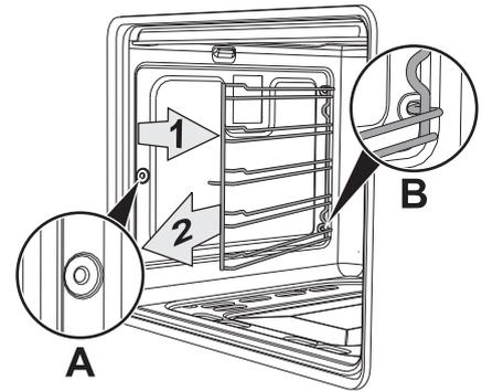
Au terme du nettoyage, répétez les opérations qu'on vient de décrire pour repositionner les châssis des glissières.
