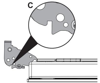
Pour remonter la porte, introduisez les charnières dans les fentes prévues à cet effet sur les rainures C sont complètement posées contre la base des fentes. Abaissez la porte puis, après l'avoir positionnée, sortez les pivots des trous des charnières.
