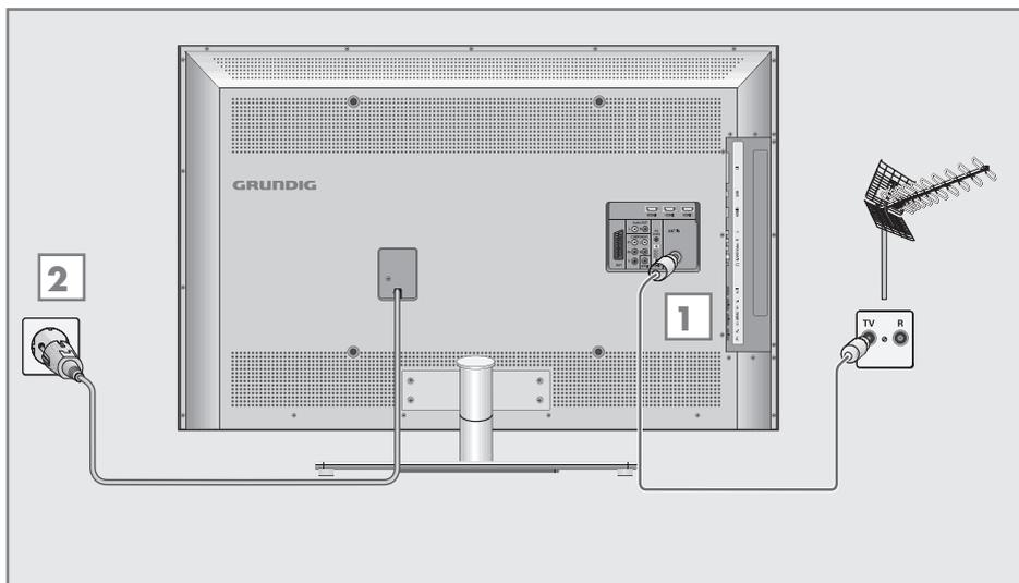
**1** Pour recevoir les stations terrestres numériques (DVB-T), branchez le câble de l'antenne de toit ou de l'antenne intérieure (antennes passive ou active utilisées avec leur propre câble d'alimentation) dans la prise de l'antenne **»ANT IN«** de votre téléviseur.
