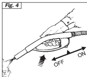
**Nota:** le témoin pression (K) s'allume et s'éteint en cours d'utilisation. Ceci est normal et indique seulement que la résistance électrique est activée afin de maintenir la pression dans la cuve. Pendant l'utilisation si une torsion excessive de la gaine se produit, le dispositif No-Volt peut interrompre le débit de vapeur. Pour que la vapeur sorte à nouveau, il suffit de rappuyer sur la poignée de commande de la vapeur.
