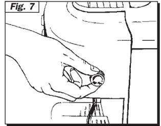
3c) Orienter la manette sortie vapeur (7) vers le bac ramasse-gouttes. Tourner légèrement le bouton jet de vapeur (6) afin d'éliminer l'eau qui reste dans le tuyau.
