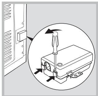
1. Pour ouvrir le bornier, faire pression à l'aide d'un tournevis sur les languettes latérales du couvercle : tirer et ouvrir le couvercle (voir figure).
