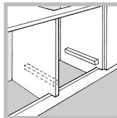
Il est conseillé d'installer le four de manière à ce qu'il repose sur deux cales en bois ou bien sur un plan d'appui continu qui ait une découpe d'au moins 45 x 560 mm (voir figures).
