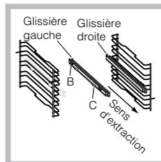
2. Choisir le niveau sur lequel monter la glissière coulissante. Positionner sur le cadre d'abord le dispositif de fixation B puis le C en veillant à bien respecter le sens d'extraction de la glissière.
