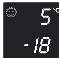
Lors de la mise en service et lorsque la température de l'appareil est trop élevée, l'affichage indique des traits jusqu'à ce que l'appareil ait atteint une température correspondant à la plage d'affichage de l'appareil (entre 19°C et 0°C dans le réfrigérateur, moins de 0°C dans le congélateur).
