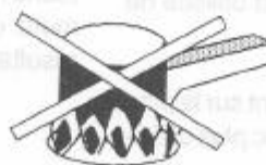
MAUVAIS Gaspillage de gaz
