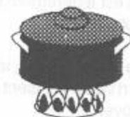
BON Les flammes ne dépassent pas : économie de gaz
