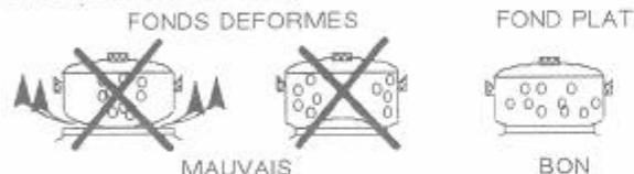
Le fond rigoureusement plat supprimera les points de surchauffe sur lesquels les aliments attachent, et l'épaisseur du métal permettra une parfaite répartition de la chaleur.
