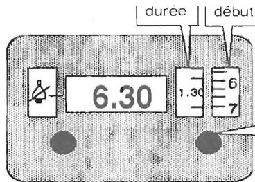
Vérifier que l'heure de début de cuisson est la même que l'heure du cadran. Dans le cas contraire, amener le chiffre "0" sur le cadran "durée" ensuite, tirer et tourner le bouton vers la droite jusqu'au cran.
