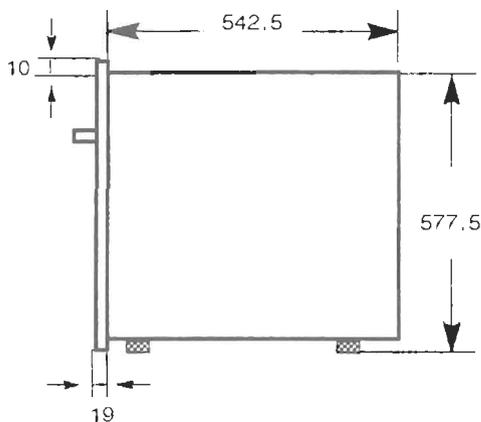
La fixation du four sur le meuble se fait sur l'encolureur situé sous la porte du four par 2 vis (non livrées)
