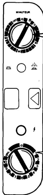
Placer le minuteur sur manuel (
