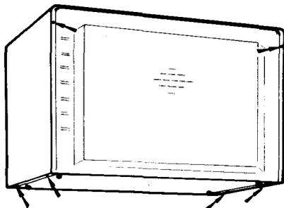
Enlever les 4 vis de fixation situées sous le four et les 2 vis situées à l'arrière.
