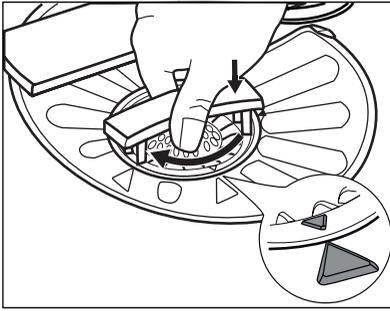
6. Assemblez le filtre **(A)** et mettez-le en place dans le filtre **(B)**. Tournez-le vers la droite jusqu'à la butée.
