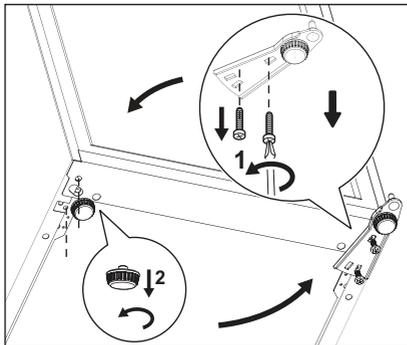
6. Montez la charnière de la porte et le pied correspondant sur le côté opposé, puis montez l'autre pied desserré à l'endroit précédent, comme le montre l'illustration. Veillez à bien placer les vis dans l'orifice droit comme illustré ci-contre. Le bord de la charnière est parallèle au flanc de l'appareil.
