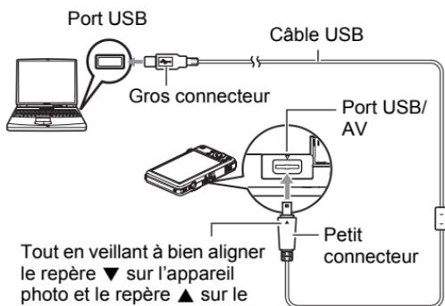
Tout en veillant à bien aligner le repère ▼ sur l'appareil photo et le repère ▲ sur le connecteur du câble USB, branchez le câble sur l'appareil photo.
