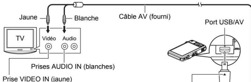
Tout en veillant à bien aligner le repère ▼ sur l'appareil photo et le repère ▲ sur le connecteur du câble AV, branchez le câble sur l'appareil photo.
