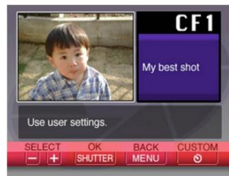
6. L'appareil photo revient au mode REC après l'enregistrement de la configuration. Vous pouvez maintenant procéder de la façon indiquée à la page F-68 pour sélectionner une scène et enregistrer une image.
