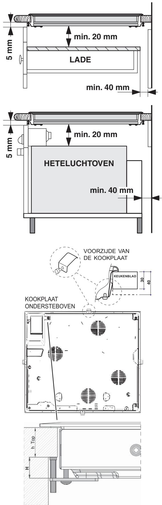
Het apparaat moet op een absoluut horizontaal oppervlak worden geïnstalleerd.
