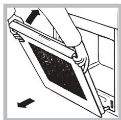
3. segure a porta dos dois lados exteriores e feche-a novamente devagar mas não inteiramente; Em seguida puxe a porta para a frente e retire-a do seu lugar (veja a figura). Para montar novamente a porta realize, na ordem contrária, as mesmas operações.
