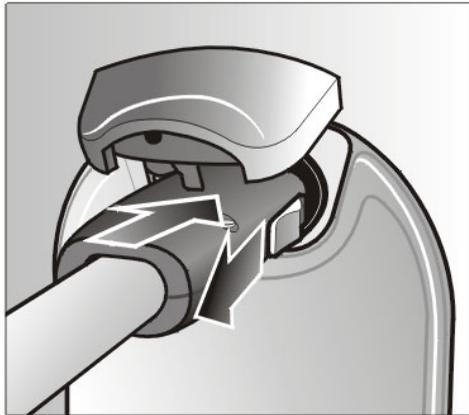
Vous pouvez à présent de nouveau brancher le fer à repasser ou le steamer sur le raccordement de vapeur du centre de repassage vapeur.
