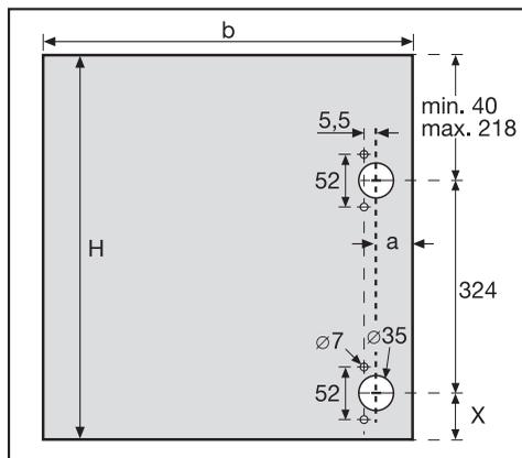
Si la largeur ( $b$ ) est plus importante, la cote  $a$  doit être augmentée
