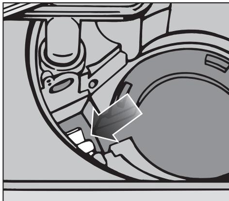
Sous le clapet anti-retour se trouve la pompe de vidange (flèche).
