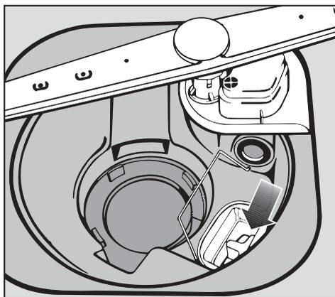
La pompe de drainage se trouve dessous la soupape de retenue (voir la flèche).
