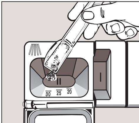
Les marques horizontales dans le Compartiment II indique des niveaux d'environ  $1 \frac{1}{4}$ ,  $1 \frac{3}{4}$  et 2 cuillérées à table (20, 25 et 30 ml) respectivement.
