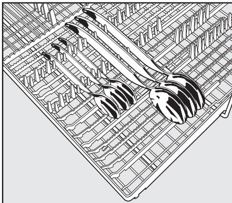
Les têtes des cuillers devraient être mises en contact avec au moins un des supports du plateau à couverts pour s'assurer que l'eau puisse s'écouler librement.
