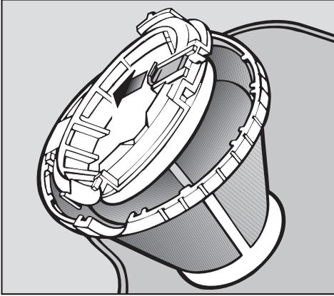
Pour nettoyer le dessous du filtre, l'onglet doit être ouvert:
