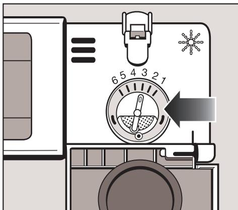
Le sélecteur de quantité est réglé à l'usine à 3. Cela déverse environ 3 ml de produit de rinçage par programme. Il peut être ajusté de 1 à 6.
