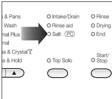
Une fois que le réservoir de sel est rempli, l'adoucisseur d'eau est automatiquement réactivé la prochaine fois que le lave-vaisselle est mis en marche. L'indicateur "Salt" sera allumé durant ce processus.
