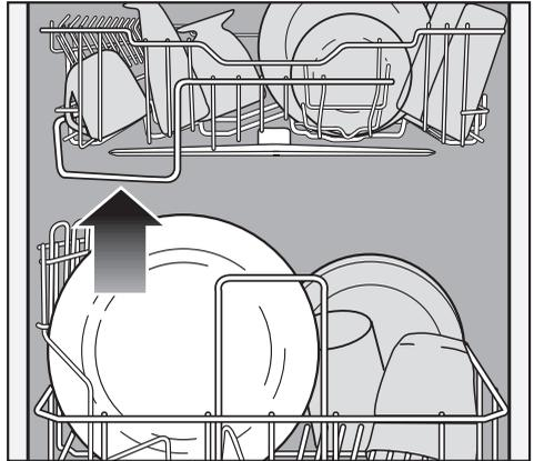
Le guide se trouvant à l'avant du panier supérieur détermine la hauteur maximale des articles placés dans le panier inférieur afin que le bras gicleur du milieu ne soit pas bloqué.
