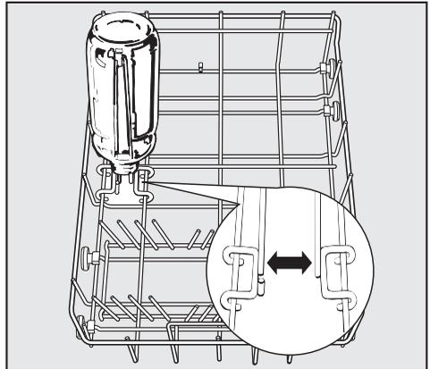
Le support à bouteilles a été conçu pour laver les articles minces par ex. bouteille de lait ou biberon. Pour de meilleurs résultats, placer le support à bouteilles dans le panier inférieur tel qu'illustré. Les jets peuvent atteindre l'intérieur des bouteilles dans cette position.
