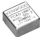
SO-2 Oscillateur Cristal à Compensation Thermique (TCXO)
