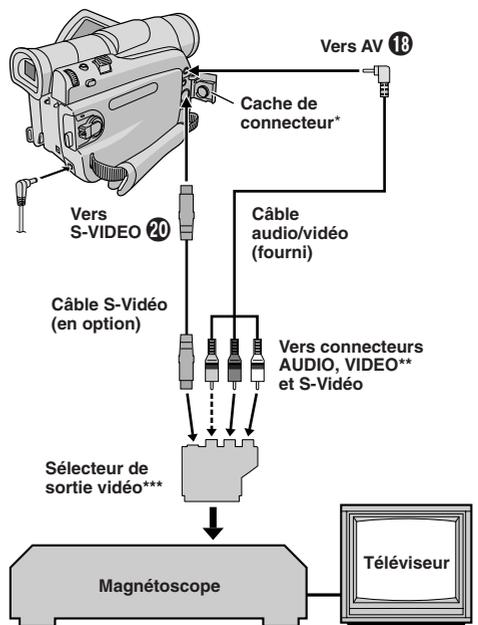
\* Pour raccorder les câbles, ouvrir ce cache.
