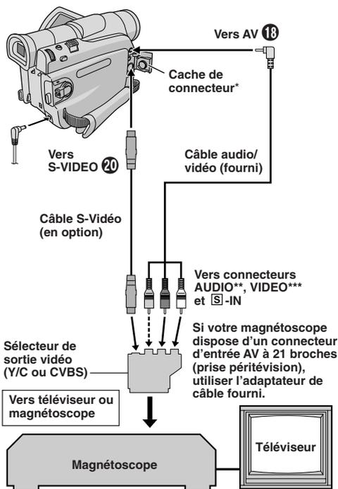
\* Pour raccorder les câbles, ouvrir ce cache.
