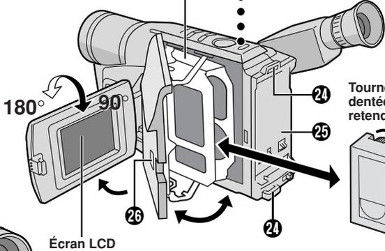
Tourner la roue dentée pour retendre la bande.
