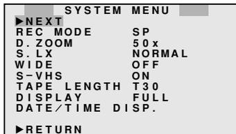
**3** Appuyer sur MENU **1** pour afficher le menu de réglage et tourner MENU **1** pour sélectionner le réglage désiré.
