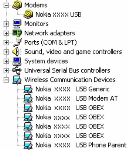
الرسم التوضيحي 1. عملية تثبيت ناجحة (يمثل الأرقام الأربعة التي تشكل رقم طراز الهاتف الذي تستخدمه)
