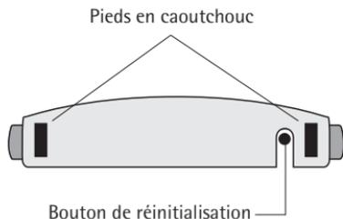
Utilisez-le pour placer l'adaptateur en mode de configuration (voir le *Guide de l'utilisateur avancé*, fourni sous forme de fichier PDF Acrobat sur le CD-ROM).
