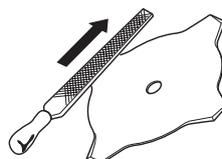
Maintenir un avoyage correct de la lame d'éclaircissage! Suivre nos instructions et utiliser le gabarit d'affûtage recommandé. Une lame d'éclaircissage mal affûtée augmente le risque de blocage et de rebond ainsi que d'endommagement de la lame.
