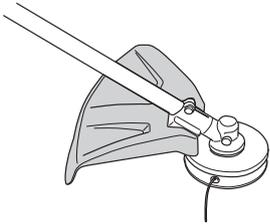
S'assurer que la protection est intacte et qu'elle ne présente pas de fissures. Remplacer la protection si elle a subi des coups ou si elle présente des fissures.
