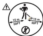
Les machines équipées de lames d'éclaircissage ou de disques à herbe peuvent être projetées violemment d'un côté quand la lame heurte un objet fixe. Ce phénomène est appelé rebond. La lame peut amputer un bras ou une jambe. Veiller à ce que les personnes et les animaux soient toujours à au moins 15 mètres de la machine.
