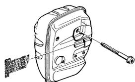
**REMARQUE!** Ne jamais utiliser la machine si le silencieux est en mauvais état.
