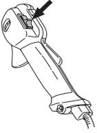
Mettre le moteur en marche et s'assurer qu'il s'arrête lorsque le bouton d'arrêt est amené en position d'arrêt.
