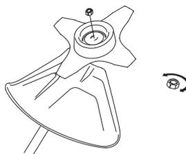
Les dents de la lame d'éclaircissage risquent de causer des blessures aussi bien lors du serrage que du desserrage de l'écrou de la lame. Veiller à ce que la main soit toujours protégée par le protège-lame lors de ces interventions. Toujours utiliser une clé à douille munie d'un manche assez long. La flèche sur l'illustration indique la zone dans laquelle la clé doit être utilisée, aussi bien pour serrer que pour desserrer l'écrou.
