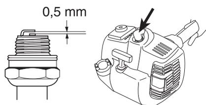
**REMARQUE!** Toujours utiliser le type de bougie recommandé! Une bougie incorrecte peut endommager le piston/le cylindre.
