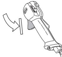
Appuyer sur le blocage de l'accélération et vérifier qu'il revient de lui-même en position initiale quand il est relâché.
