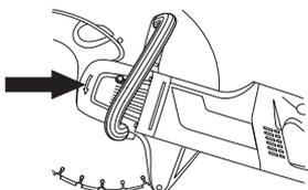
Lors du remplacement d'un disque découpeur par un disque neuf, contrôler les rondelles d'accouplement et l'arbre d'entraînement. Voir les indications à la section Contrôle de l'arbre d'entraînement et des rondelles d'accouplement.
