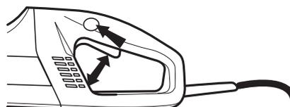
Démarrer la machine, relâcher l'interrupteur et contrôler que le moteur et le disque découpeur s'arrêtent.
