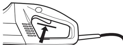
Appuyer sur le blocage de l'interrupteur et vérifier qu'il revient en position initiale quand il est relâché.
