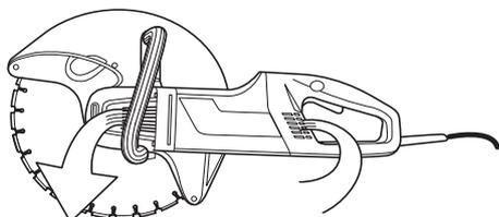
Pour que le refroidissement de la machine fonctionne correctement, les ouvertures de l'air de refroidissement doivent être propres et ne pas être bouchées. Nettoyer régulièrement la machine à l'air comprimé.
