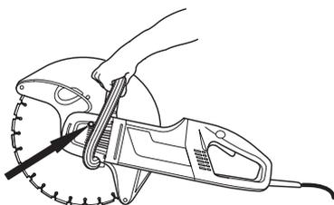
Si une lame diamant est montée sur la découpeuse, veiller à ce qu'elle tourne dans la direction indiquée par la flèche sur la lame.
