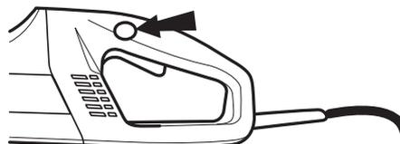
Vérifier que l'interrupteur, le blocage de l'interrupteur et le système de ressorts de rappel fonctionnent correctement.
