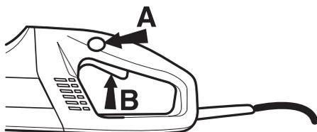
Le blocage de l'interrupteur reste enfoncé tant que l'interrupteur est enfoncé. Quand la poignée est relâchée, l'interrupteur et le blocage de l'interrupteur reviennent en position initiale. Ce retour s'effectue grâce à deux systèmes de ressorts de rappel indépendants l'un de l'autre. Dans cette position, la machine s'arrête et l'interrupteur se bloque.
