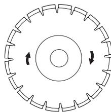
Une flèche se trouve à l'arrière de la machine et indique le sens de rotation de l'arbre du disque.
