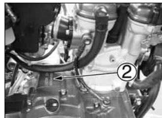
1. Matricola telaio 2. Matricola motore
